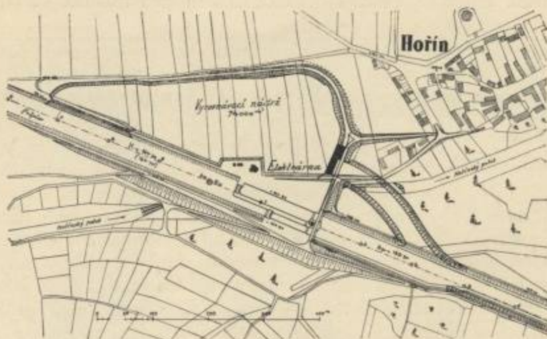
Obr. 63. Návrh situace vodní elektrárny u Hořína.
