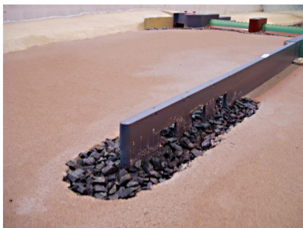
Obr. 2.2 Hydraulický model dělicí zdi horní rejdy.
