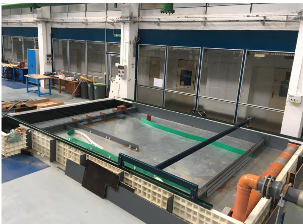
Obr. 4.1 Funkční vzorek – univerzální hydraulický model zdymadel na LVVC.
