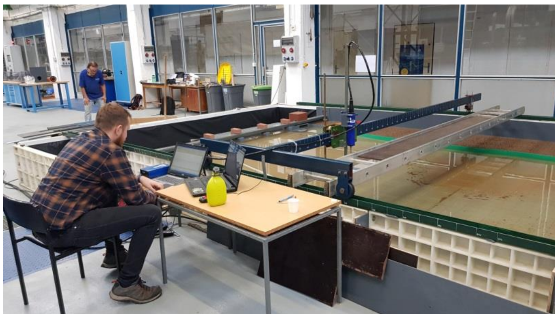
Obr. 5.3 Měření rychlostního pole v oblasti zdymadla Lysá nad Labem.
