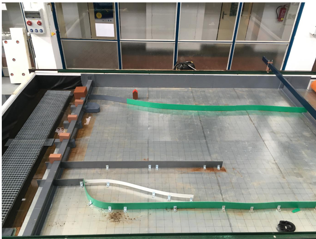
Obr. 4.2 Pohled na funkční vzorek s pozinkovým dnem pro snadné magnetické připevňování jednotlivých dispozičních prvků.
